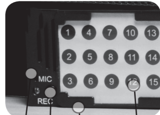
Microfono Pulsante di registrazione Unità di registrazione Numeri di pagina di riproduzione
